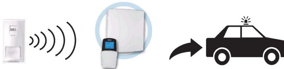
Un capteur détecte. ►► Le système de contrôle est alerté. ►► Une alerte est déclenchée et la Télésurveillance est informée.
